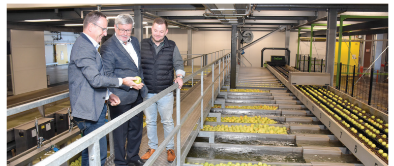
Benno Neff erklärt Werner und Matthias Fleischmann die Sortieranlage für Äpfel, die automatisch Grösse, Farbe, Gewicht und Mängel erkennt und für Bauern die Abnahmemengen mit Preis errechnet (mehr Infos dazu auf www.fleischmann.ch/news ).
